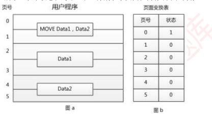
图 a 中 MOVE Data1,Data2 是一个 4 字节的指令,Data1 和 Data2 表示该指令的两个 32 位操作数。假设 MOVE 指令存放在 2047 地址开始的内存单元中,Data1 存放在 6143 地址开始的内存单元中,Data2 存放在 10239 地址开始的内存单元中,那么执行 MOVE 指令将产生\_\_(26)\_\_ 次缺页中断,其中:取指令产生\_\_(27)\_\_ 次缺页中断。
